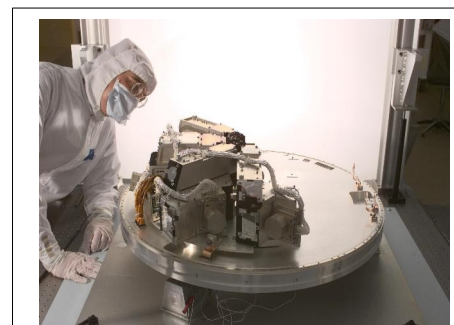
Figur 27: Spektrometer, IRS, til at analysere det infrarøde lys. Der er yderligere to instrumenter om bord. Et fotometer samt et infrarødt kamera. [32]
