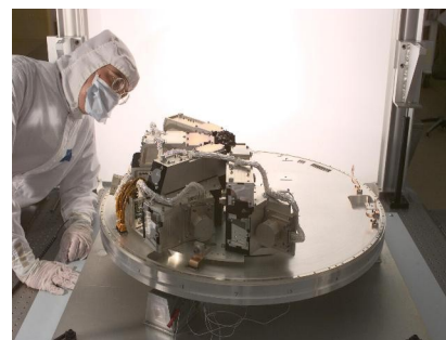
Figur 66: Spektrometer, IRS, til at analysere det infrarøde lys. Der er yderligere to instrumenter om bord. Et fotometer samt et infrarødt kamera. [32]
