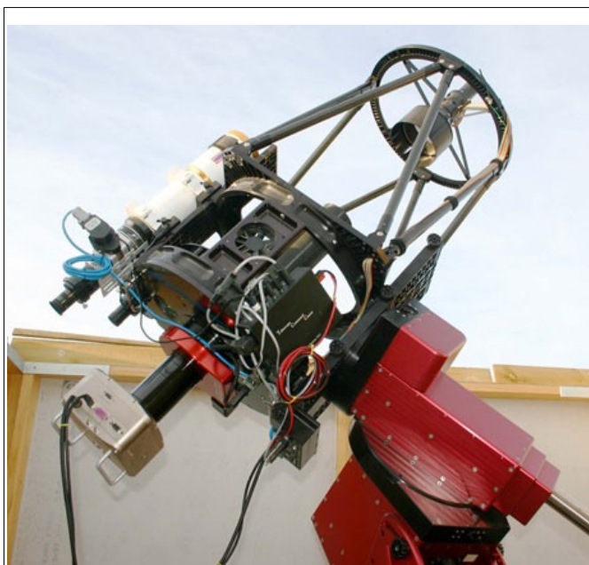
Figur 103: Et teleskop med en detektor anbragt i enden. Læg mærke til at det ikke er nødvendigt med et kikkertrør, såfremt man observerer på et mørkt og ustøvet sted. [13].
